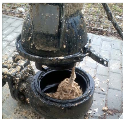
Pompa zatkana m.in. chusteczkami
